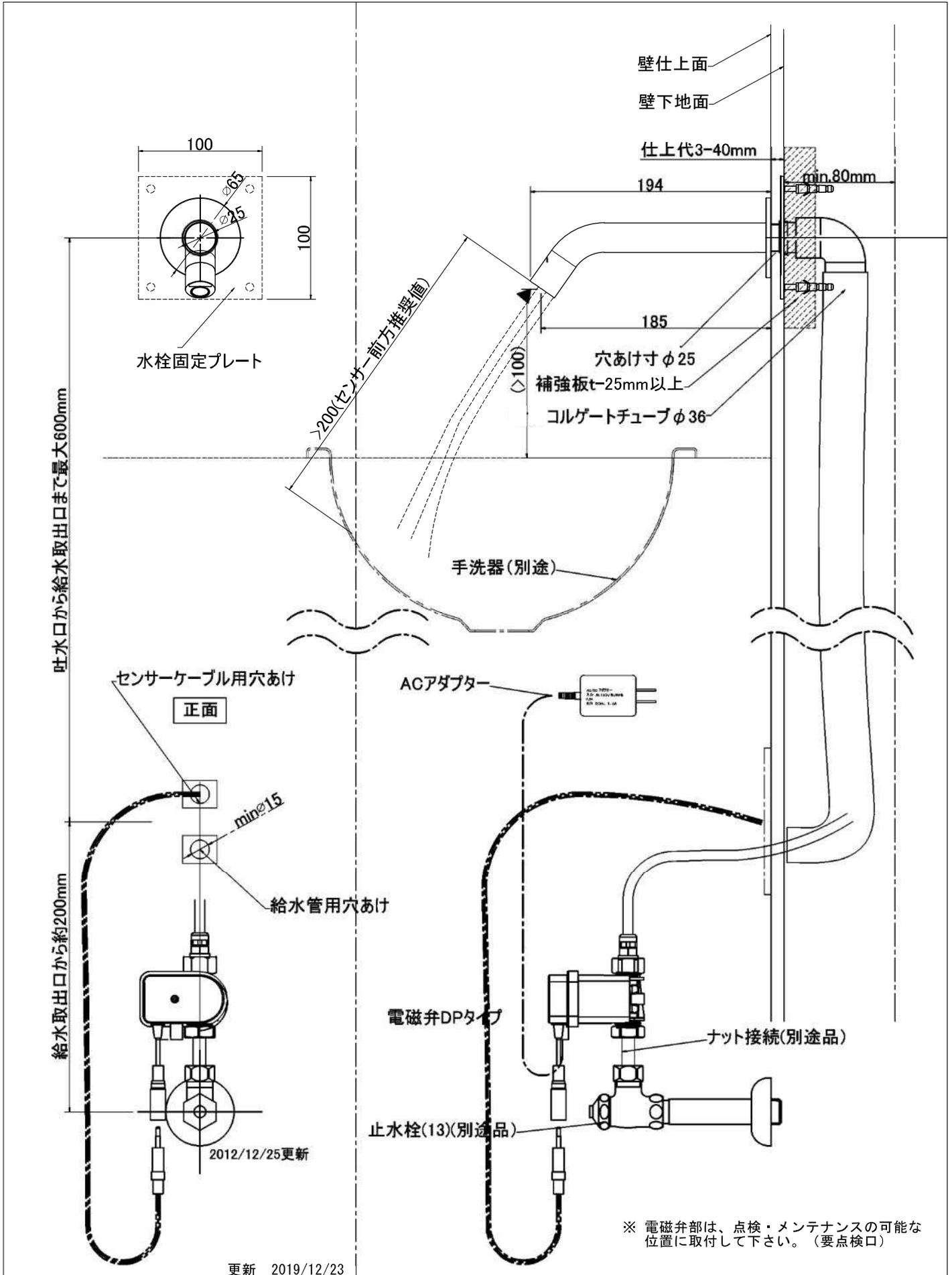
※ 電磁弁部は、点検・メンテナンスの可能な位置に取付して下さい。(要点検口)
