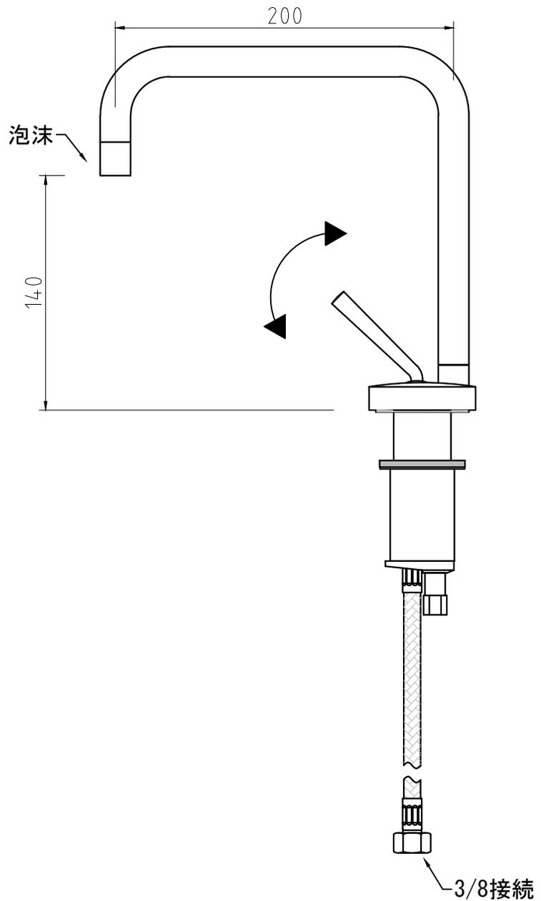
取付穴径  $\phi 35 \sim 40\text{mm}$
