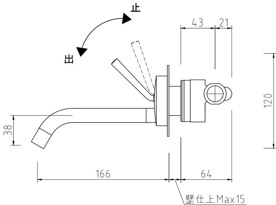
取付穴径  $\phi 60 \sim \phi 65$
